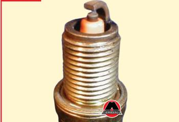
На фото №1 изображена свеча зажигания, вывернутая из нормально работающего двигателя. Юбка центрального электрода имеет светлоржавый цвет, нагар и отложения минимальны, полное отсутствие следов масла. Такой двигатель обеспечивает оптимальные показатели расхода топлива и моторного масла.
