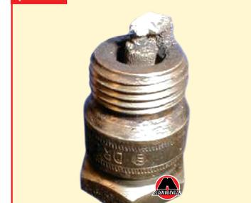
Свеча зажигания, изображенная на фото №8, имеет электрод, покрытый золотыми отложениями. При этом цвет отложений не играет решающей роли. Причина такого налета – сгорание масла вследствие износа или залпания масляных поршневых колец. На двигателе наблюдается повышенный расход масла, из выхлопной трубы валит синий дым. Процедура замены поршневых колец описывается в главе «Механическая часть двигателя».
