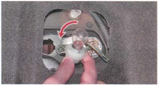
4. Утопив и повернув против часовой стрелки до упора, извлекаем **из** патрона неисправную лампу, и заменяем ее.
