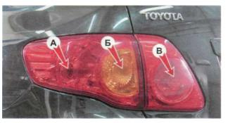
Расположение ламп в заднем фонаре автомобиля Toyota Corolla выпуска до 2010 г: А — лампа габаритного света и сигнала торможения W21/5W; Б — лампа указателя поворота P21W; В — лампа света заднего хода (правый фонарь) W16W, лампа противотуманного света (левый фонарь) W21W
