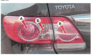
Расположение ламп в заднем фонаре автомобиля Toyota Corolla выпуска с 2010 г: А — лампа габаритного света и сигнала торможения W21/5W; Б — лампа указателя поворота P21W; В — лампа света заднего хода (правый фонарь) W16W, лампа противотуманного света (левый фонарь) W21W
