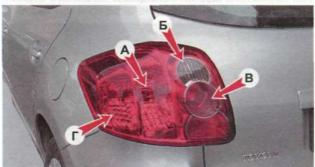
Расположение ламп в заднем фонаре автомобиля Toyota Auris: А — лампа габаритного света W5W; Б — лампа указателя поворота P21W; В — лампа света заднего хода (правый фонарь) W16W, лампа противотуманного света (левый фонарь) W21W; Г — лампа сигнала торможения W21W
