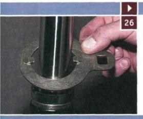
[27] Вращая динамометриченый ключом специальный ключ, затягиваем гайку моментом, указанным производителем амортизатора.
