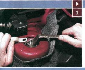
[2] Снимаем верхние опорную шайбу и резиновую подушку штока.
