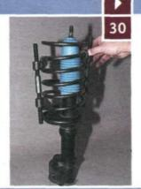
Устанавливаем направляющую пружинную стойку на автомобиль в обратной последовательности.
