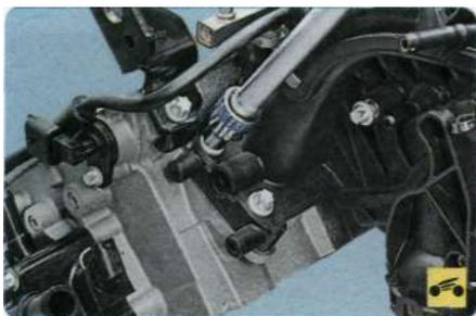
2. Выверните болты крепления впускной трубы к головке блока цилиндров...
