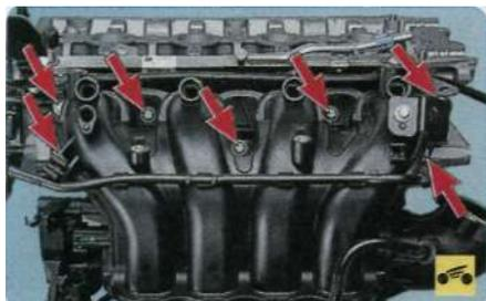
Так расположены болты крепления впускной трубы к головке блока цилиндров.
