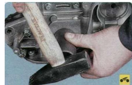
7. Смажьте рабочую кромку нового сальника моторным маслом, установите его
