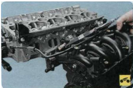
и снимите впускную трубу.
