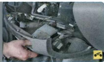
15. Снимите центральную облицовку паш приборов (см. «Снятие и установка панели приборов», с. 267).
