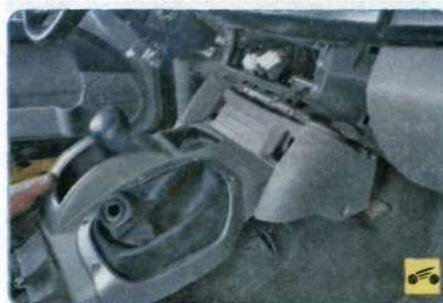
20. Потяните на себя и вверх и снимите переднюю часть облицовки тоннеля пола.
