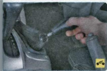
114. Отверните рукоятку и снимите ее с рычага управления раздаточной коробкой.
