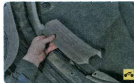
4. ...потяните вверх и, преодолевая сопротивление пистонов крепления, снимите облицовку заднего порога.
