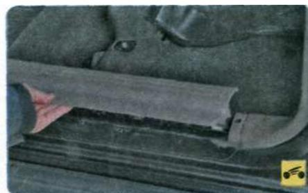
2. Подденьте монтажной лопаткой, потяните вверх и, преодолевая сопротивление пистонов крепления, снимите облицовку переднего порога.
