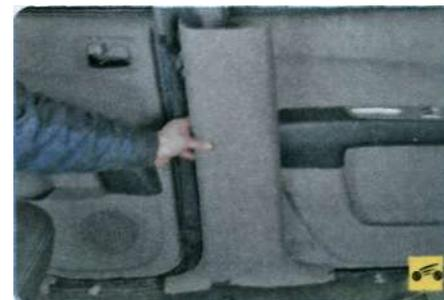
6. ...и снимите нижнюю облицовку средней стойки кузова.
