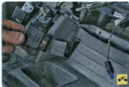
18. Отожмите фиксатор колодки, отсоедините колодку жгута проводов и снимите клавишу включения обогрева сиденья водителя.
