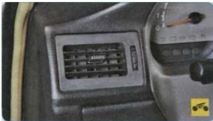
**1, 11 - боковые сопла системы отопления, кондиционирования и вентиляции.** Предназначены для направления потока воздуха из отопителя, кондиционера и системы вентиляции (см. «Отопление, кондиционирование и вентиляция салона», с. 21).
