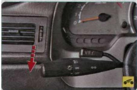
...или вниз до включения указателей поворота. При перемещении рычага вверх или вниз в комбинации приборов начинает мигать сигнализатор 2 левого указателя поворота или сигнализатор 4 правого указателя поворота (см. рис. 1.12). При возврате рулевого колеса в положение прямолинейного движения рычаг автоматически устанавливается в исходное положение. При смене полосы движения для включения указателя поворота достаточно нажать
