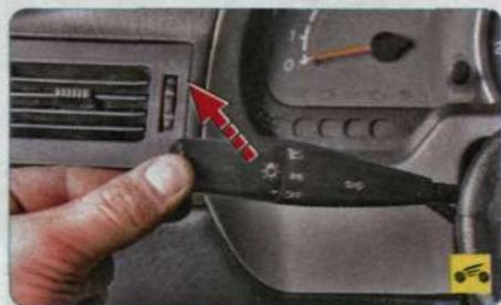
...переместите рычаг по направлению от рулевого колеса - в комбинации приборов загорится сигнализатор 15 (см. рис. 1.12) включения дальнего света фар;
