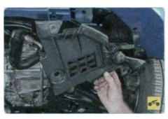
2. Снимите защиту картера и нижнюю часть левого брызговика двигателя (см. «Снятие и установка брызговиков и защиты картера двигателя», с. 71).
