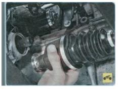
2. Снимите привод правого переднего юлеса (см. «Снятие и установка приводов передних колес», с. 167).
