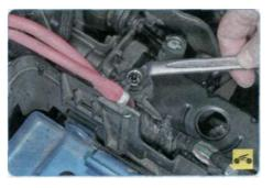
5. Отверните гайку крепления кожуха аккумуляторной батареи...
