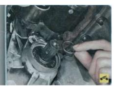
3. Снимите с хвостовика полуосевой шестерни резиновое уплотнительное юльцо.
