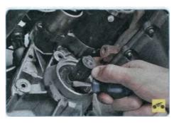
4. Поддев отверткой, извлеките сальник из гнезда в картере коробки передач.
