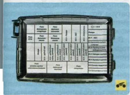
На внутреннюю сторону крышки монтажного блока реле и предохранителей с моторного отсека нанесена схема расположения предохранителей и реле.
