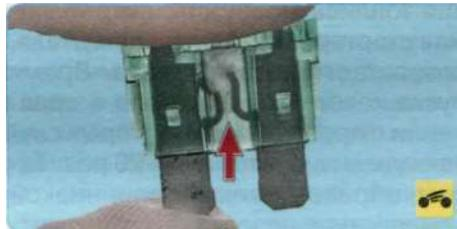
Так выглядит перегоревший предохранитель (показанная стрелкой перемычка внутри держателя перегорела и разомкнулась). Для замены используйте запасной предохранитель того же номинала (и цвета).
