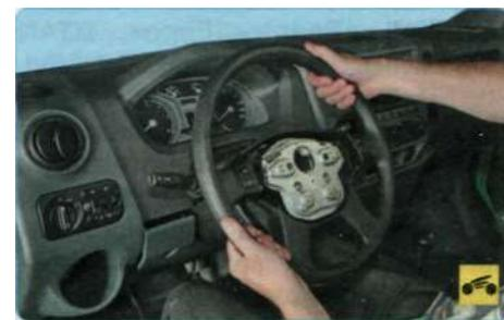
2. Снимите рулевое колесо (см. «Снятие и установка рулевого колеса», с. 172).
