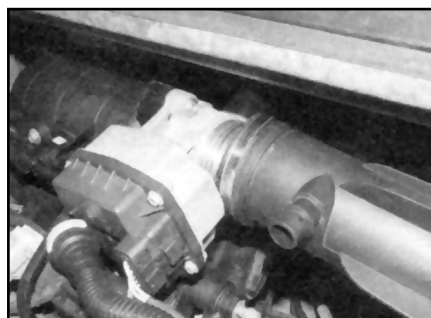
2.5а Отсоедините колпак воздухоочистителя от корпуса дроссельной заслонки...
