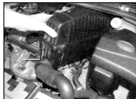
2.5б ...перемещая воздухоочиститель вверх для освобождения от нижней опоры
