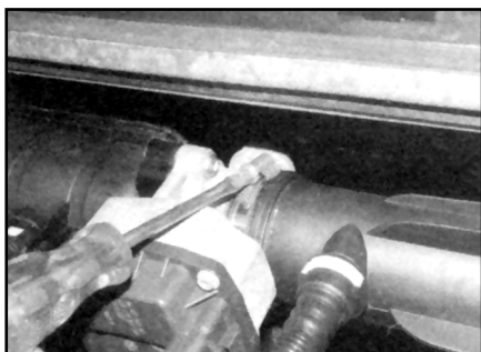
2.1 Ослабьте хомут, крепящий колпак воздухоочистителя к корпусу дроссельной заслонки
