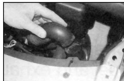
2.3 Отсоедините пластмассовый шланг забора воздуха от впускного воздуховода резонатора или от воздухоочистителя
