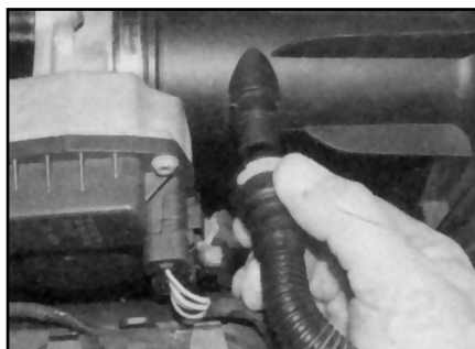
2.2 Освободите зажимы на разъеме и отсоедините шланг сапуна от колпака воздухоочистителя
