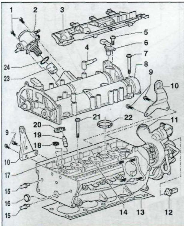
20.1a Детали установки и сборки головки цилиндров
