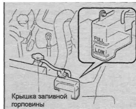
3. Проверьте подтекание охлаждающей жидкости,
