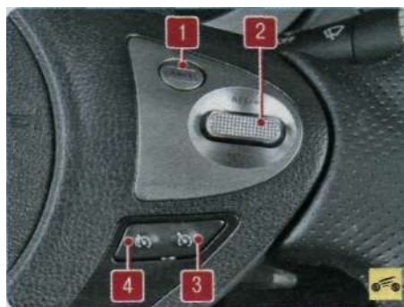
Рис. 1.10. Блок управления системой круиз-контроля и ограничения максимальной скорости: 1 - кнопка отмены; 2 - переключатель ускорения и восстановления скорости; 3 - кнопка выключателя круиз-контроля; 4 - кнопка выключателя ограничителя скорости
