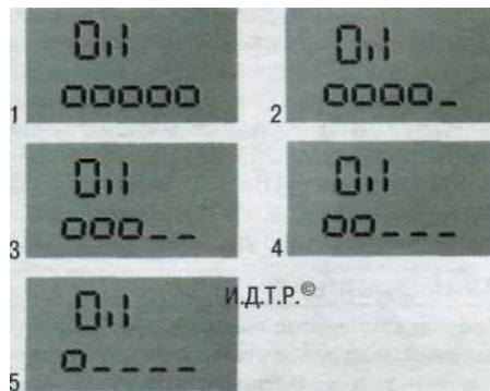
Рис. 1.9. Информация об уровне моторного масла: 1 - уровень моторного масла 1 (высокий); 2 - уровень моторного масла 2; 3 - уровень моторного масла 3; 4 - уровень моторного масла 4; 5 - уровень моторного масла 5 (низкий)
