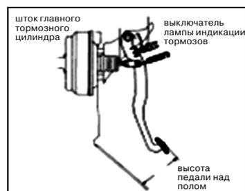
3. Плоскогубцами отвернуть контргайку штока главного тормозного цилиндра. Вра-
