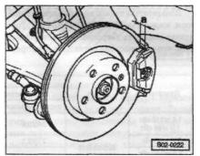
Если толщина торм. накладки (вкл. опорную плиту) станет меньше, чем 7,5 мм, то абсолютно необходимо заменить тормозные накладки на целом мосту. Установив колеса в помеченном положении, затянуть болты крепления колес с приложением 120 Нм. После замены накладок тормозных колодок несколько раз крепко нажать в остановленном а/м педаль управления торм. системой до конца, чтобы накладки тормозных колодок вошли в положение, соответствующее рабочему состоянию.
