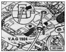
Заправлять жидкость "ATF" с применением бачкадля доливки (ресивера) -VAG 1924стрелка- до тех пор, пока жидкость "ATF не начнет вытекать из контрольного отверстия.
