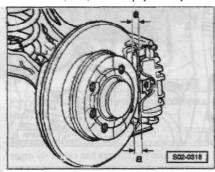
Если толщина торм. накладки (вкл. опорную плиту) станет меньше, чем 7,5 мм, то абсолютно необходимо заменить тормозные накладки на целом мосту. Установив колеса в помеченном положении, затянуть болты крепления колес с приложением 120 Нм. После замены накладок тормозных колодок несколько раз крепко нажать в остановленном а/м педаль управления торм. системой до конца, чтобы накладки тормозных колодок вошли в положение, соответствующее рабочему состоянию.
