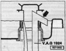
Затянуть резьбовую пробку для контроля жидкости "АТF" -стрелка-, снабженную новым уплотн. кольцом, с приложением 80 Нм. Завершить диагностику (автоматический контроль) а/м. Выключить двигатель. При выключенном зажигании отсоединить диагностический, измерительный и информационный прибор -VAS 5051- от центрального штекера на а/м для присоединения диагностического стенда. Установить звукоизоляцию.
