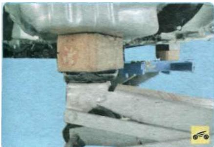
2. Установите домкрат через деревянную подставку под поддон картера двигателя и приподнимите силовой агрегат, разгрузив тем самым его опоры.
