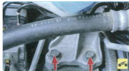
12. Выверните два болта верхнего крепления правой опоры к кронштейну кузова.
