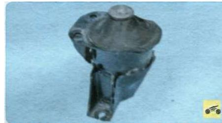
15. Осмотрите опору. При обнаружении трещин, отслоения резины от обоймы или при появлении трещин в кронштейнах замените опору.
