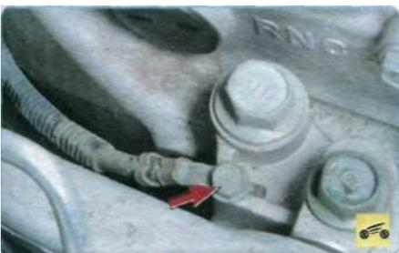
3. Выверните болт крепления массового провода...
