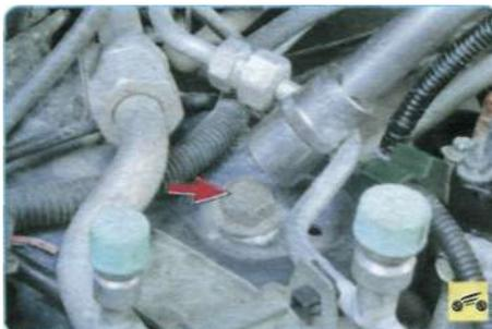
7. Выверните болт заднего крепления реактивной тяги...
