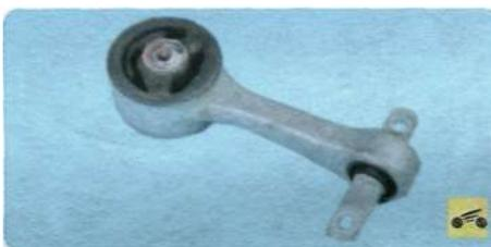
9. Осмотрите реактивную тягу. При наличии вспучивания, растрескивания массива резины, отслоения его от стальной втулки или при появлении трещин в кронштейнах замените тягу.
