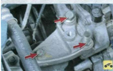
10. Выверните два болта и отверните гайку крепления кронштейна к блоку цилиндров двигателя...
