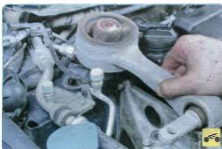
8. ...и снимите реактивную тягу с автомобиля.
