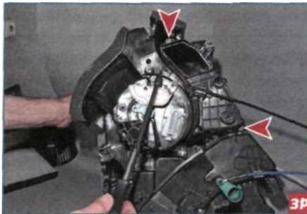
Тем же инструментом отворачиваем два самореза с левой стороны отопителя...
