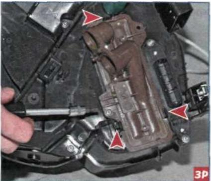
Ключом Тогх Т-20 отворачиваем саморез и, отжав три фиксатора...
