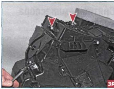
Ключом Тогх Т-20 отворачиваем три самореза в нижней части отопителя.
