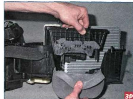
Отклеив поролоновый уплотнитель, снимаем щиток испарителя.
