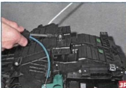
...и саморез в передней части отопителя.
