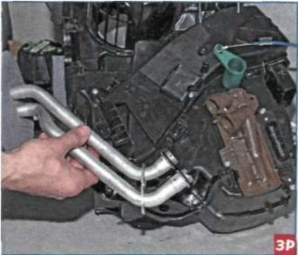
...и снимаем трубки радиатора отопителя.
