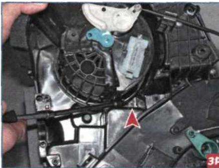
...саморез, расположенный в углублении ниже дополнительного резистора вентилятора отопителя...
