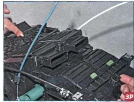
Отжимаем две защелки в передней части...
