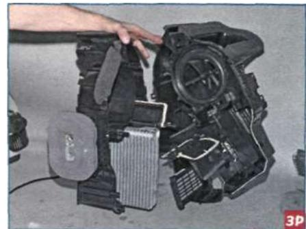
...и разъединяем левую и правую части корпуса отопителя.
