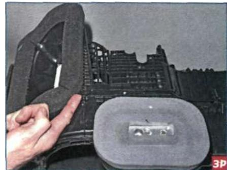
...и одну защелку в задней части отопителя...
