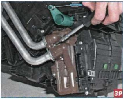
Ключом Тогх Т-20 отворачиваем винт...
