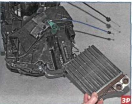
...и вынимаем радиатор отопителя.
