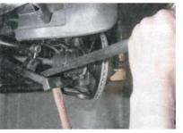
Молотком наносим удары по проушине поворотного кулака, одновременно нажимая монтажной лопаткой на рычаг вниз.
