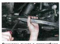
Снимаем рычаг с автомобиля, выводя его сайлент-блоки монтажной лопаткой из подрамника.
