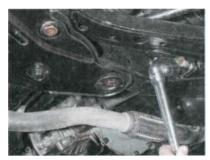
Головкой «на 19» отворачиваем болт крепления переднего сайлент-блока рычага.
