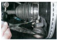
Ключом «на 19» не полностью отворачиваем гайку пальца шаровой опоры.
