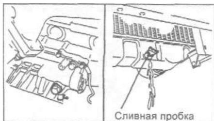
3. Снимите расширительный бачок и слейте из него охлаждающую жидкость.
