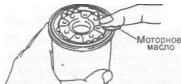
5. Рукой наверхните фильтр на посадочное место до момента контакта прокладки с привалочной поверхностью блока цилиндров.
