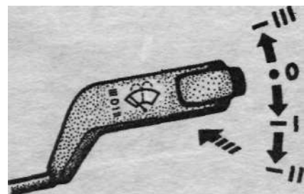
Рис. 1.9. Положения рычага переключателя очистителя и омывателя стекла (без звукового сигнала)
