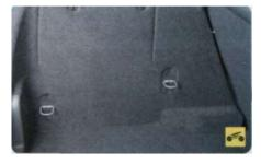
На боковых обивках багажника установлены откидные петли для крепления багажа.
