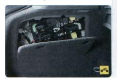
...под которой установлен дополнительный монтажный блок предохранителей и реле.
