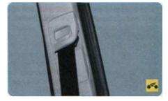
На автомобиле также предусмотрена регулировка передних ремней безопасности по высоте.
