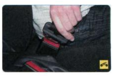
...и вставьте язычок пряжки в замок до щелчка, не допуская скручивания лямок.
