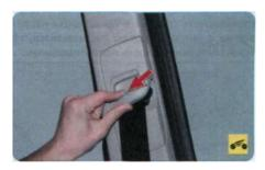
Для регулировки положения ремня отожмите фиксатор...
