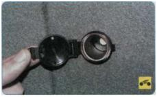
...а также может быть установлена розетка для подключения дополнительных электроприборов.
