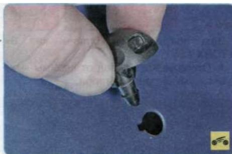
5. Поверните форсунку в любую сторону до совпадения выступа на ее штуцере с вырезом в отверстии капота и снимите форсунку.
