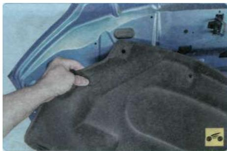
2. Снимите шумоизоляцию капота см. «Снятие и установка капота», с. 000).
