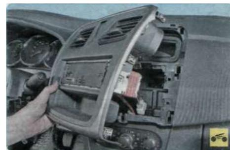
Для снятия головного устройства аудиосистемы снимите верхнюю декоративную накладку панели приборов (см. «Снятие и установка элементов панели приборов», с. 290)...
