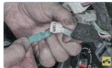
...отсоедините колодки жгутов проводов и антенны и извлеките головное устройство из гнезда в накладке.
