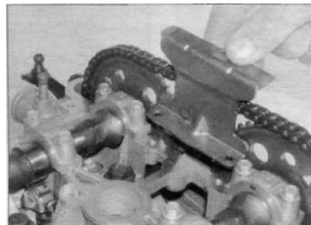
Рис. 8.37. Воспользуйтесь новыми болтами крепления успокоителя
