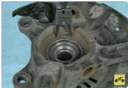
2. Съемником стопорных колец снимите стопорное кольцо.
