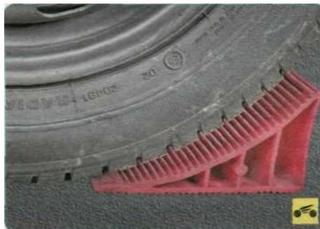
3. ...и установите противооткатные упоры («башмаки») под задние колеса.
