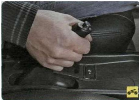
2. Затормозите автомобиль стояночным тормозом...
