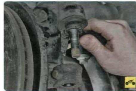
9. Отсоедините наконечник рулевой тяги от рычага поворотного кулака (см. «Замена наружного наконечника рулевой тяги», с. 159).
