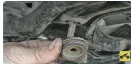
8. ...и снимите гайку, шайбу и резиновую втулку со стойки стабилизатора поперечной устойчивости.
