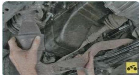
6. Снимите приемную трубу системы выпуска отработавших газов (см. «Снятие и установка приемной трубы», с. 113).
