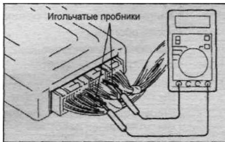
2. При подсоединенном разъеме электронного блока управления измерьте напряжение между выводами "массы" электронного блока управления и каждым соответствующим выводом разъема блока.
