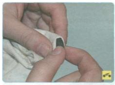
80. Очистите магнит от частиц износа деталей. Если на магните появились трещины или ослаблены его магнитные свойства, замените магнит
