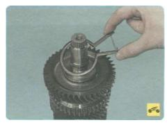
3. Снимите, сжав усики, пружинное стопорное кольцо...
