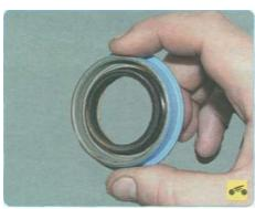
77. При обнаружении в процессе эксплуатации утечки масла через сальники и при износе их рабочих кромок сальники необходимо заменить.
