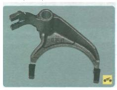
76. Проверьте состояние вилок переключения передач. Если они погнуты либо изношены лапки, замените эти детали.
