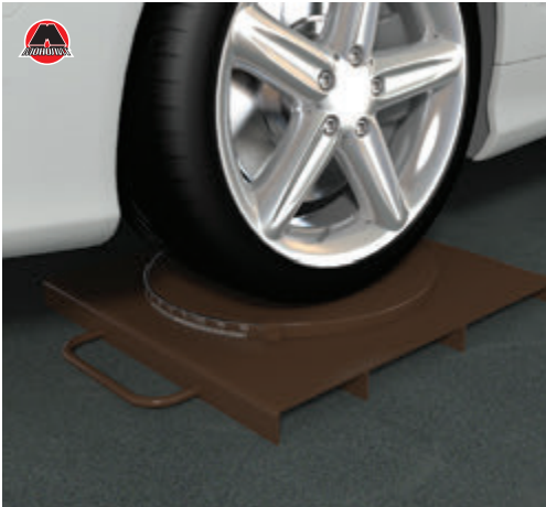
Рисунок 2.19 Поворотные подставки под передние колеса для отработок руления.
