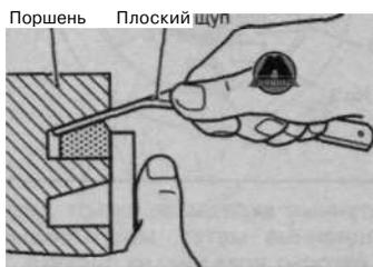
2. Вложить кольцо в отверстие цилиндра и продавить его головкой поршня, чтобы оно заняло перпендикулярное к оси цилиндра положение. Затем при помощи плоского щупа измерить зазор в замке кольца. Если величина зазора превышает предельно-допустимое значение, заменить поршневые кольца новыми.
