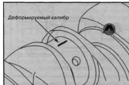
3. Осторожно установить крышку шатуна с вкладышем.
