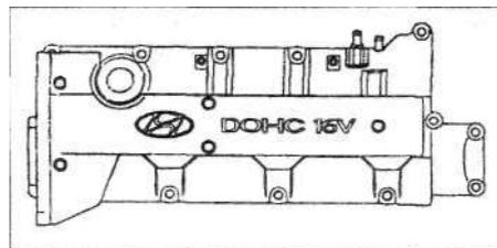
4. Отверните болты крепления верхней крышки ремня привода ГРМ и затем снимите крышку.
