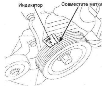
б) Проверьте, что отверстие в шкиве распределительного вала совмещено с установочной меткой на крышке переднего подшипника распределительного вала. При этом метки на звездочках распределительных валов должны быть совмещены с метками на цепи. Если совмещения нет, то проверните коленчатый вал на один оборот (360°).
