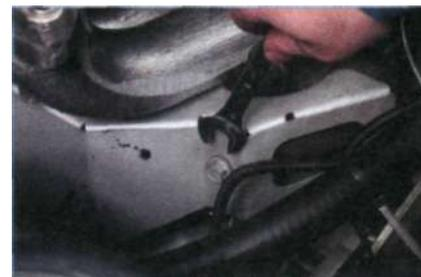
Ключом «на 13» отворачиваем три болта крепления теплозащитного экрана выпускного коллектора...
