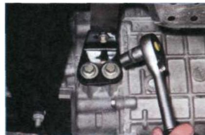
Головкой «на 13» отворачиваем два болта крепления кронштейна приемной трубы к картеру коробки передач...
