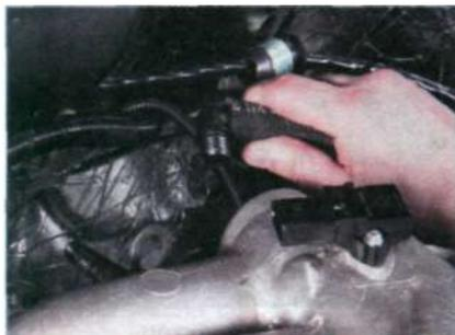
Вынимаем наконечник шланга вакуумного усилителя тормозов из отверстия на заднем торце ресивера.
