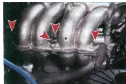
Расположение гаек крепления ресивера к впускной трубе.
