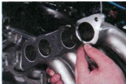
Снимаем с фланца ресивера уплотнительную прокладку.
