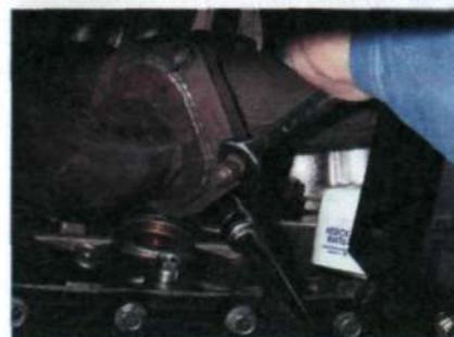
Головкой «на 14» отворачиваем контргайку крепления фланцев при-
