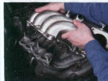
Снимаем ресивер со шпилек впускной трубы.
