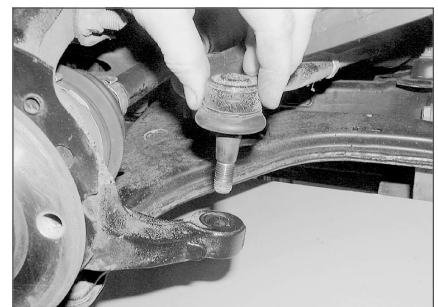
Рис. 24.4,б. ...отсоедините рулевой наконечник от поворотного кулака
