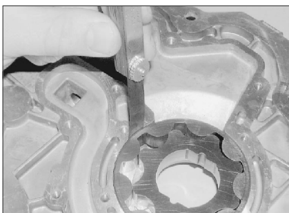
Рис. 13.7,б. ...измерьте зазор между наружным ротором и корпусом насоса...
