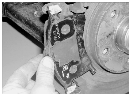
Рис. 4.6,а. Снимите наружную колодку с кронштейна крепления...
