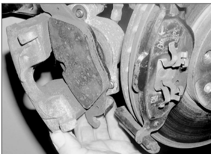
Рис. 4.5,в. Снятие суппорта с поворотного кулака — модели Astra
