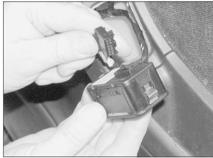
Рис. 44.2,г. ...и отсоедините разъем проводки
