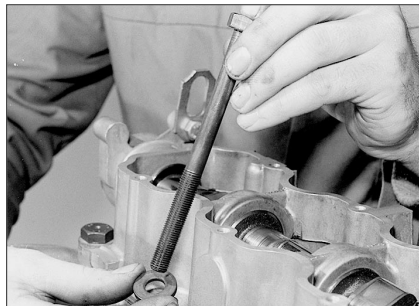
Рис. 12.29 Установите шайбы на новые болты крепления головки цилиндров
