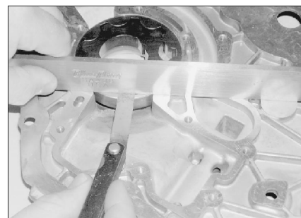
Рис. 13.7,в. ...и проверьте осевой зазор
