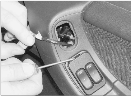
Рис. 44.2,в. Выньте переключатель электрических стеклоподъемников...
