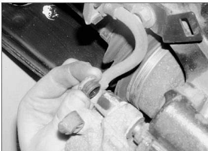
Рис. 4.4 Снимите пылезащитные колпачки...
