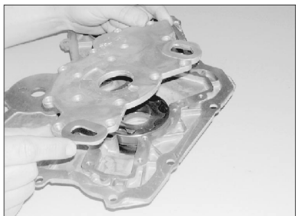
Рис. 13.2 Отверните болты крепления и снимите крышку насоса
