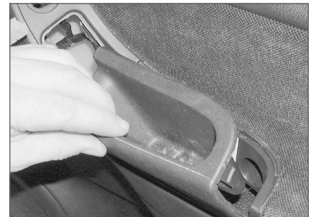
Рис. 44.6,в. ...и снимите накладку с внутренней панели двери
