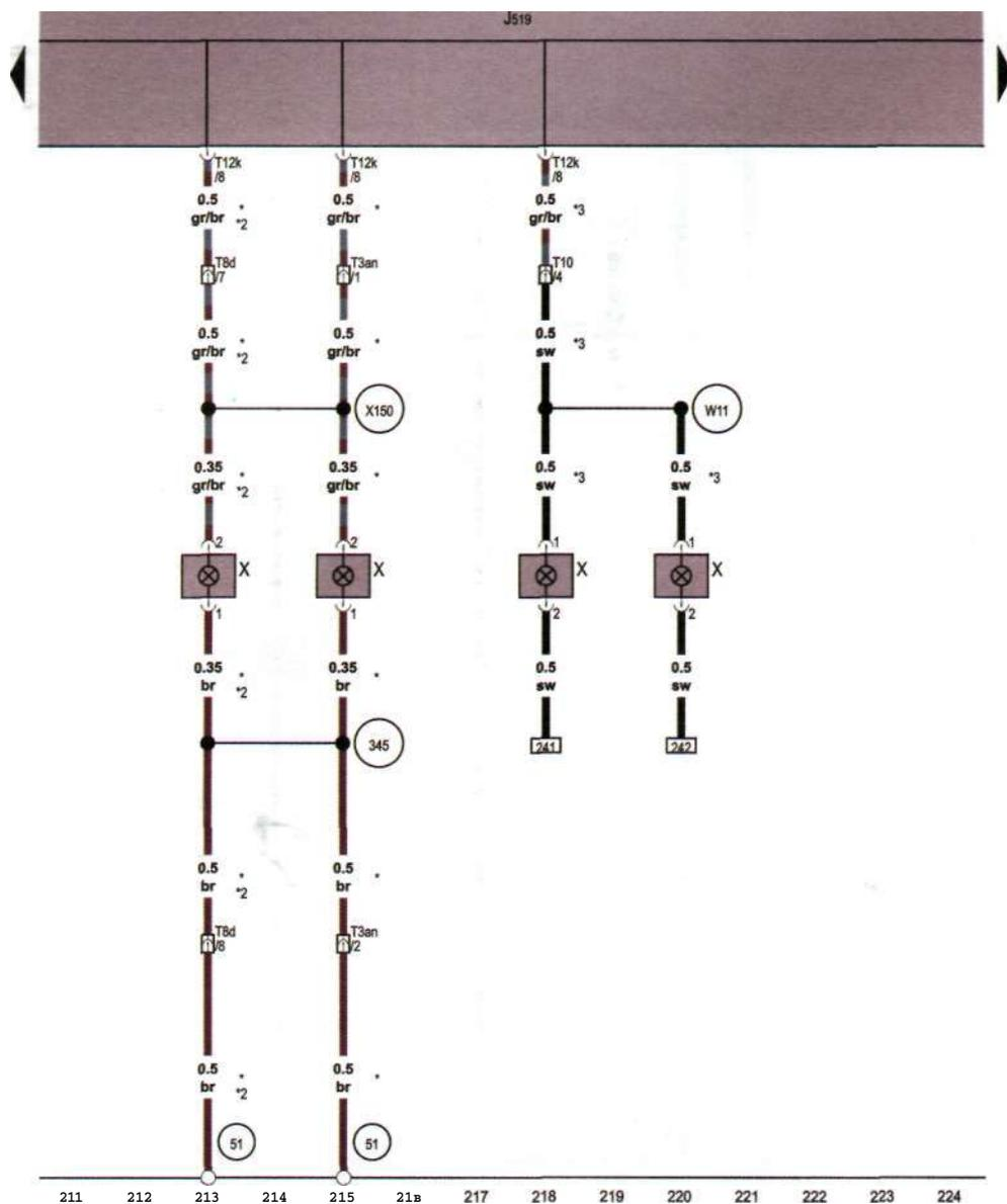
J519 — блок управления электрической бортовой сетью
