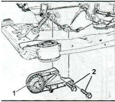
7.20 Болты крепления передней опоры к картеру коробки передач
