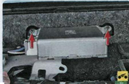
3. Отверните две гайки..
