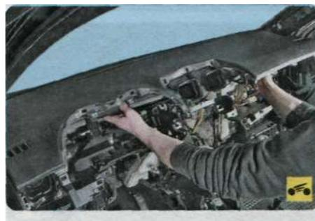
2. Снимите верхнюю часть панели приборов (см. «Снятие и установка верхней части панели приборов», с. 231).
