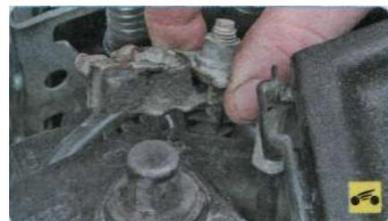
1. Отсоедините провод от клеммы «минус» аккумуляторной батареи.
