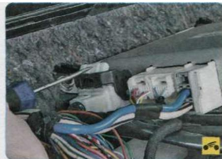
6. Подденьте отверткой и отожмите фиксатор...
