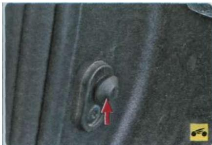
Выключатели плафона освещения салона установлены в отверстиях дверных стоек кузова. Вам потребуется ключ TORX T30.
