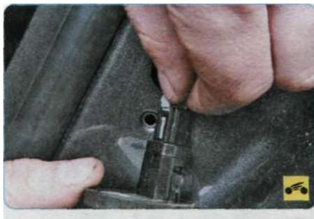
4. Отсоедините колодку жгута проводов и снимите выключатель,
