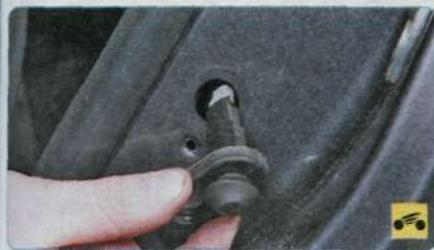
3. ...и извлеките выключатель плафона освещения салона из отверстия в стойке кузова
