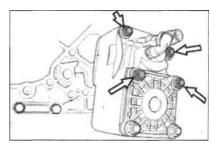
Затяните гайки указанным моментом. Спецификации: 35 ± 5 Н»м
