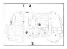
Коробка передач, вид снизу Слейте масло из коробки передач, вывернув сначала сливную пробку (2), а затем пробку контроля уровня (1).
