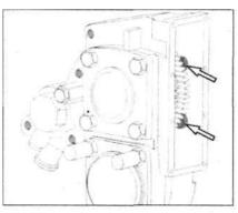
Отвернув болты, снимите коробку отбора мощности назад. Выверните болты полностью. Снимите коробку отбора мощности и вал отбора мощности. Затяните сливную пробку (2) указанным моментом.
