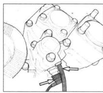
Отсоедините электрические разъемы и пневматические соединители.
