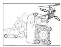
Подсоедините электрические разъемы и пневматические соединители.
