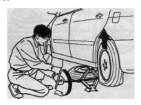
4. Отверните гайки крепления колеса и снимите заменяемое колесо.
