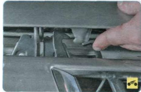
Затем приподнимите капот и через образовавшуюся щель отожмите лапку предохранительного крючка.
