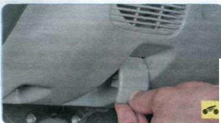
Для получения доступа в моторный отсек потяните на себя рукоятку привода замка капота.
