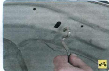
...и установите упор в специальное гнездо капота.
