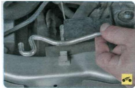
Поднимав капот, извлеките упор капота из держателя на рамке радиатора...
