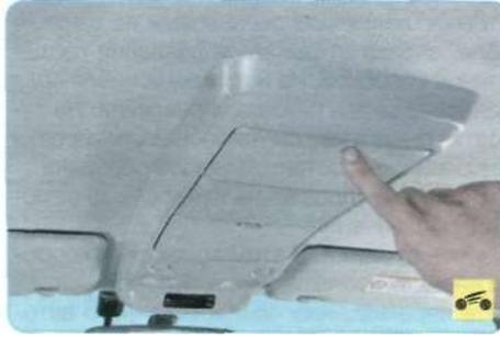
Для открывания отсека для хранения пластиковых карт нажмите на край крышки...
