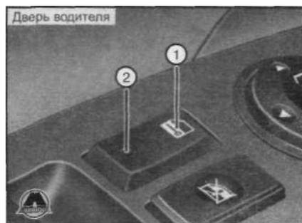
• При нажатии на переднюю часть (1) клавиши переключателя замки всех дверей автомобиля будут заблокированы.
