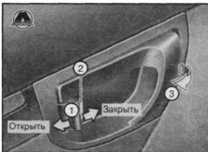
• Если потянуть внутреннюю ручку двери водителя (или переднего пассажира) в тот момент, когда кнопка блокировки двери находится в закрытом положении, произойдет разблокировка этой кнопки, и дверь откроется (при наличии).
