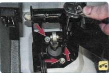
2. Отверните три гайки крепления кронштейна педали и снимите педаль в сборе с кронштейном.
