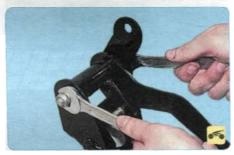
4. Придерживая ось от проворачивания вторым ключом, отверните гайку...
