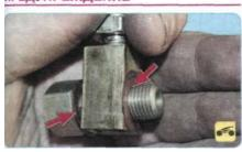
Не потеряйте медные уплотнительные шайбы, установленные c двух сторон соединительной муфты шланга.
