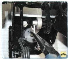
1. Под панелью приборов извлеките шплинт из отверстия пальца педали сцепления.
