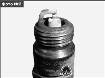
На фото №3 изображена свеча из двигателя, топливовоздушная смесь которого в отличие от предыдущего случая слишком обеднена. Цвет электрода такой свечи зажигания от светло-серого до белого. При работе на бедной смеси эффективная мощность двигателя падает. При использовании такой смеси она долго не воспламеняется, а процесс сгорания происходит с нарушениями, сопровождаемыми неравномерной работой двигателя.
