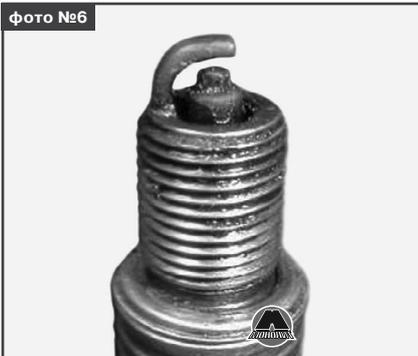
Свеча зажигания, показанная на фото №6, вывернута из неработающего цилиндра. Центральный электрод такой свечи, а также его юбка покрыты плотным слоем масла смешанного с каплями не-
