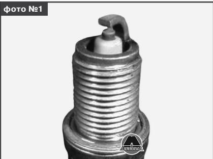
На фото №1 изображена свеча зажигания, вывернутая из нормально работающего двигателя. Юбка центрального электрода имеет светло-коричневый цвет, нагар и отложения минимальны, полное отсутствие следов масла. Такой двигатель обеспечивает оптимальные показатели расхода топлива и моторного масла.
