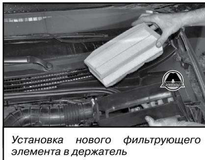
Установка нового фильтрующего элемента в держатель
