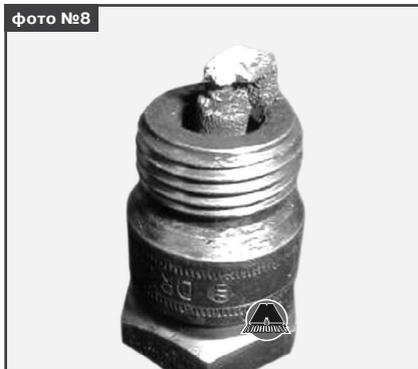
Свеча зажигания, изображенная на фото №8, имеет электрод, покрытый золотыми отложениями. При этом цвет отложений не играет решающей роли. Причина такого налета – сгорание масла вследствие износа или залипания маслоотражательных поршневых колец. На двигателе наблюдается повышенный расход масла, из выхлопной трубы валит синий дым. Процедура замены поршневых колец описывается в главе «Механическая часть двигателя».
