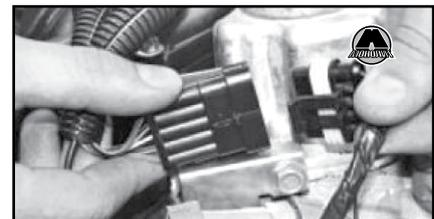
Отсоединение колодки жгута проводов катушек зажигания
