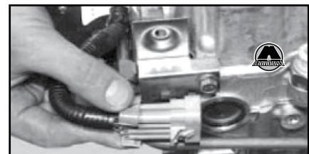
Снятие колодки жгута проводов топливных форсунок с переднего кронштейна
