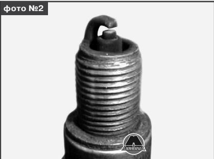
Свеча, изображенная на фото №2, вывернута из двигателя с повышенным расходом топлива. Центральный электрод такой свечи покрыт бархатисто-черным нагаром. Причинами этого могут быть богатая воздушно-топливная смесь (неправильная регулировка карбюратора или неисправность системы электронного впрыска), засорение воздушного фильтра.
