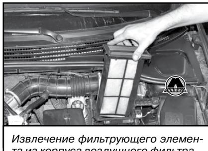
Извлечение фильтрующего элемента из корпуса воздушного фильтра
