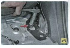
6. Выверните на несколько оборотов задний болт крепления петли...
