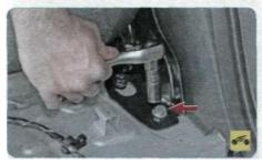
5. Полностью выверните передний болт крепления петли.
