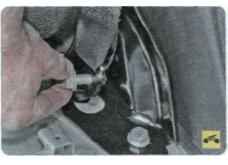
4. Выверните болт нижнего крепления левого бокового ремня безопасности и отсоедините ремень от левой петли спинки.
