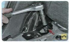
13. Выверните на несколько оборотов задний болт крепления петли...
