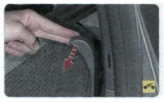
8. Отведите вперед фиксатор замка левой части спинки и наклоните ее вперед.
