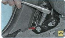
12. Выверните передний болт крепления петли.
