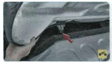
2. Приподнимите подушку до выхода двух ее направляющих из кронштейнов на кузове...
