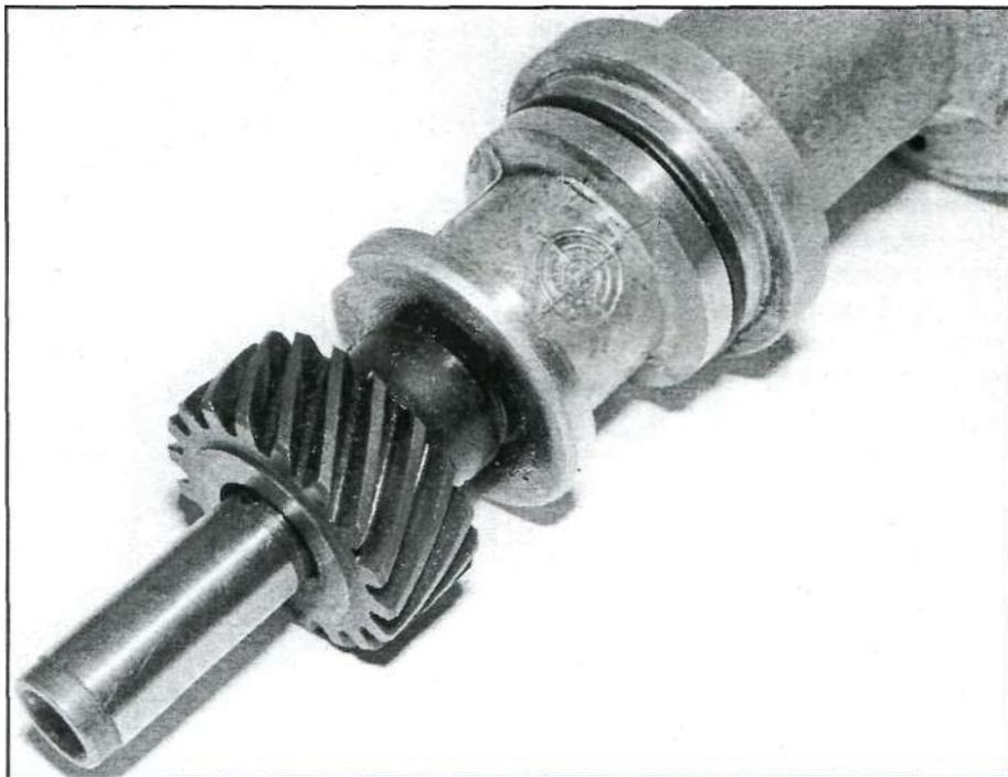
Типичный вал распределителя в сборе
