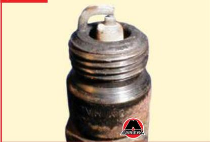
На фото №3 изображена свеча из двигателя, топливовоздушная смесь которого в отличие от предыдущего случая слишком обеднена. Цвет электрода такой свечи зажигания от светло-серого до белого. При работе на бедной смеси эффективная мощность двигателя падает. При использовании такой смеси она долго не воспламеняется, а процесс сгорания происходит с нарушениями, сопровождаемыми неравномерной работой двигателя.
