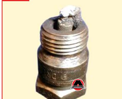
Свеча зажигания, изображенная на фото №8, имеет электрод, покрытый зольными отложениями. При этом цвет отложений не играет решающей роли. Причина такого налета – сгорание масла вследствие износа или залипания маслосъемных поршневых колец. На двигателе наблюдается повышенный расход масла, из выхлопной трубы валит синий дым. Процедура замены поршневых колец описывается в главе «Механическая часть двигателя».
