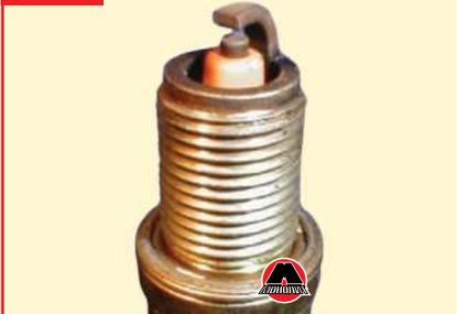
На фото №1 изображена свеча зажигания, вывернутая из нормально работающего двигателя. Юбка центрального электрода имеет светлый-коричневый цвет, нагар и отложения минимальны, полное отсутствие следов масла. Такой двигатель обеспечивает оптимальные показатели расхода топлива и моторного масла.
