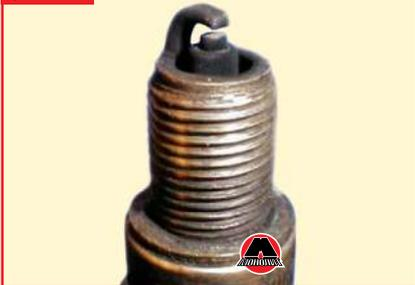
Свеча, изображенная на фото №2, вывернута из двигателя с повышенным расходом топлива. Центральная юбка такой свечи покрыта бархатисто-черным нагаром. Причинами этого могут быть богатая воздушно-топливная смесь (неправильная регулировка карбюратора или неисправность системы электронного впрыска), засорение воздушного фильтра.
