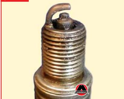
Свеча зажигания, показанная на фото №6, вывернута из неработающего цилиндра. Центральная юбка такой свечи, а также его юбка покрыты плотным слоем смешанного с каплями не-
