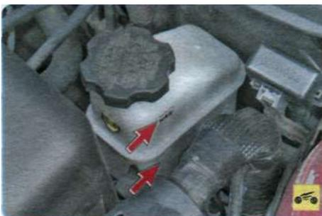
1. Проверьте уровень тормозной жидкости в бачке. Он должен находиться между метками «MIN» и «MAX», нанесенными на корпус бачка.
