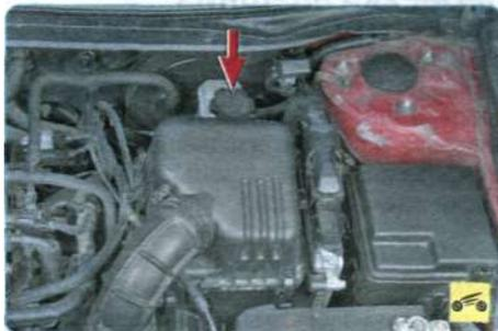
Бачок установлен на главном тормозном цилиндре с левой стороны моторного отсека у щита передка.
