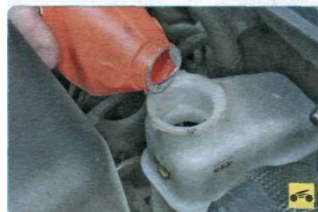
4. Долейте тормозную жидкость до метки «MAX» и заверните пробку бачка. Пролитую жидкость вытрите чистой тканью.
