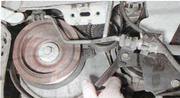
4. Нажимаем фиксатор и отсоединяем от генератора колодку провода.
