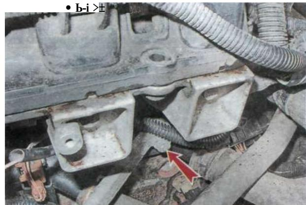
10. Ключом **на 10 мм** отворачиваем болты нижнего...
