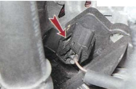
5. Осматриваем разъем и убеждаемся в отсутствии коррозии и повреждений. При необходимости обрабатываем его специальным средством для очистки электрических контактов и очищаем контакты от окислов.
