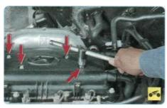
2. Выверните четыре болта крепления крышки свечных колодцев...
