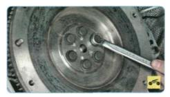
2. Выверните шесть болтов крепления маховика, удерживая маховик от проворачивания с помощью отвертки или монтажной лопатки.
