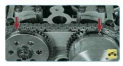
5. Проверьте совпадение меток на звездочках распределительных валов и на цепи привода газораспределительного механизма.
