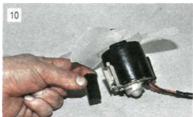
Снимаем подушки электродвигателя.
