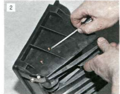
Поддеваем отверткой и снимаем две пружинные шайбы крепления корпуса дополнительного резистора к кожуху вентилятора.
