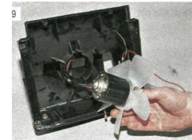
...и вынимаем вентилятор из кожуха.
