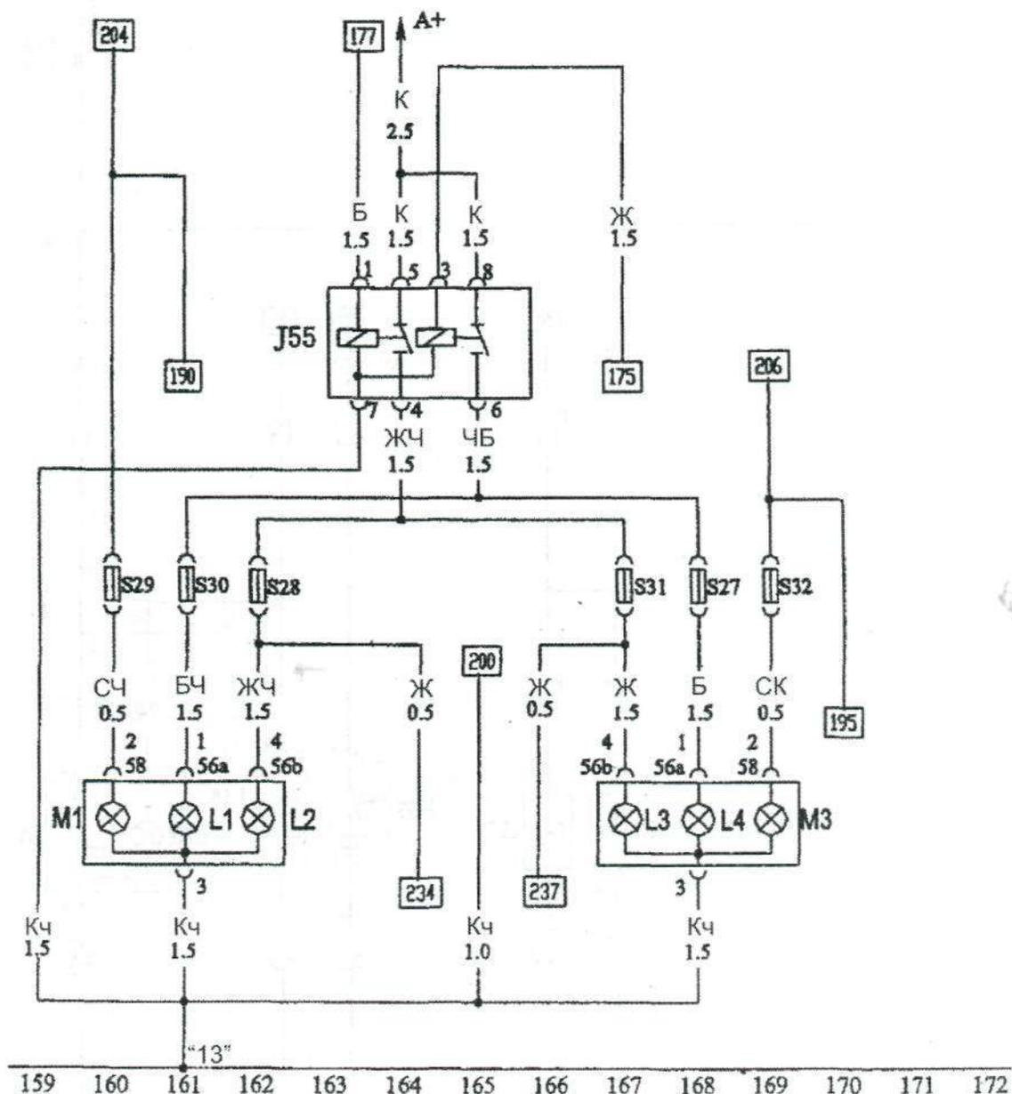
**Рис. 11.1.13. Схема подключения передних фар и реле света фар:**
