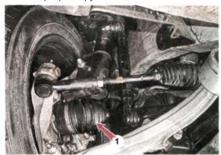
...и внутреннего 2 шарниров приводов передних колес, ищем утечки смазки из них (при подозрении, можно слегка растянуть чехол руками). Проверяем, не ослабли ли хомуты чехлов и крепления демпфера 3.
