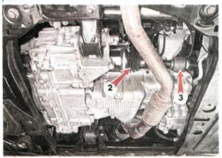
4. Поворачиваем руль так, чтобы колеса встали прямо по ходу движения. Держим одной рукой вал, а другой вращаем вперед-назад корпусы шарниров и убеждаемся в отсутствии люфта.
