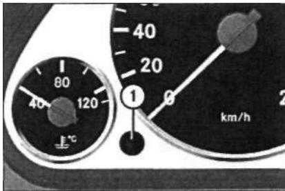
Яркость подсветки щитка приборов регулируется кнопкой 1, используемой также для сброса показаний суточного пробега (см. иллюстрацию).
