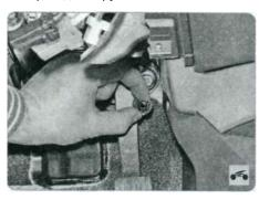
8. Под панелью приборов извлеките пистон крепления покрытия пола и откиньте покрытие,
