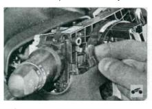
Отожмите два фиксатора крепления жней части кожуха...
