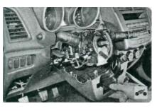
7. ...и снимите нижнюю часть кожуха рурой колонки.
